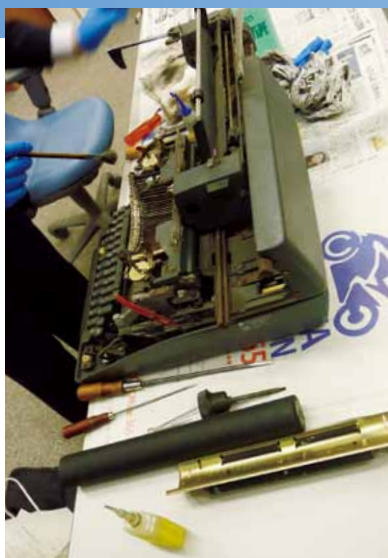
写真1 分解清掃中のビルマ文字 タイプ(左)とチベット文 字タイプ(右) (2013年 11月)。
