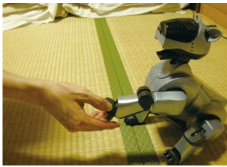
「お手」という人間の声に反応して左前足を浮かす。足底部への接触を感知すると、多くの場合喜びを表すランプを点灯する。
